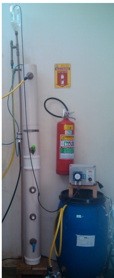
Figura 1: Reator UASB. Fonte: Autor do trabalho.
