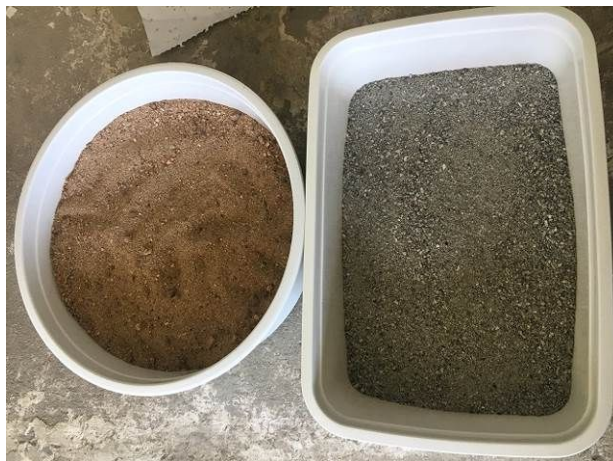
Figura 2: Amostra para realização do ensaio de peneiramento . Lado direito areia natural; Lado esquerdo o pó de pedra. Fonte: Autor do Trabalho.
