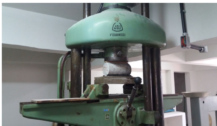
Figura 8: Ensaio de resistência à tração por compressão diametral. Fonte: Autor do trabalho.
