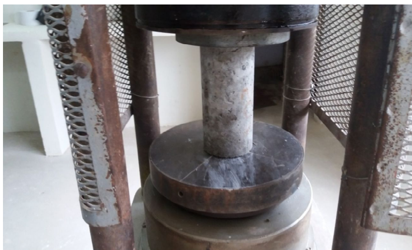
Figura 7: Ensaio de resistência à compressão. Fonte: Autor do trabalho.
