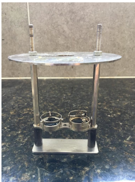
Figura 2: Aparato para a utilização do ensaio de ponto de amolecimento. Fonte: Autor do Trabalho.
