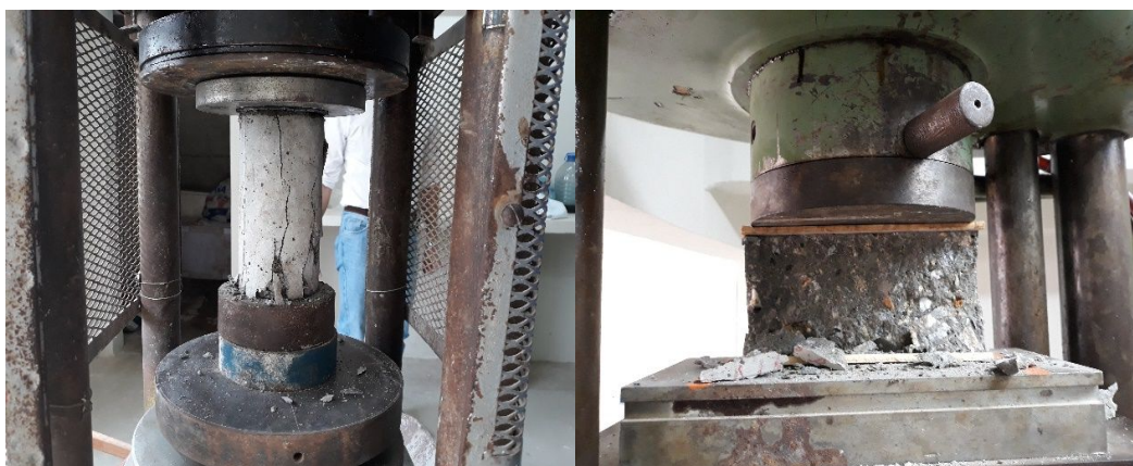
Figura 2. Ensaio de compressão simples e tração por compressão diametral. Fonte: Autoria Própria, (2018).
