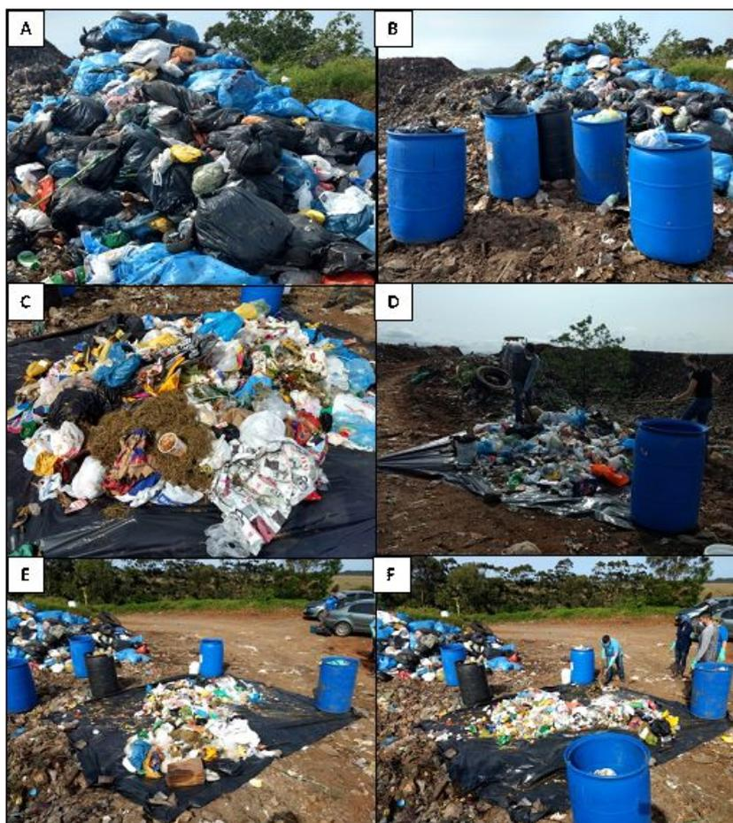
**Figura 1:** A) Pilha de resíduos provenientes dos caminhões de coleta da cidade de Xangri-lá; B) Tonéis contendo resíduos de 5 pontos da pilha; C) Resíduos dos toneis sobre a lona plástica; D) Processo de abertura e mistura dos resíduos sobre a lona plástica; E) Primeiro quartejamento com descarte vis-à-vis; F) Segundo quartejamento com descarte vis-à-vis. Fonte: Autor do Trabalho.
