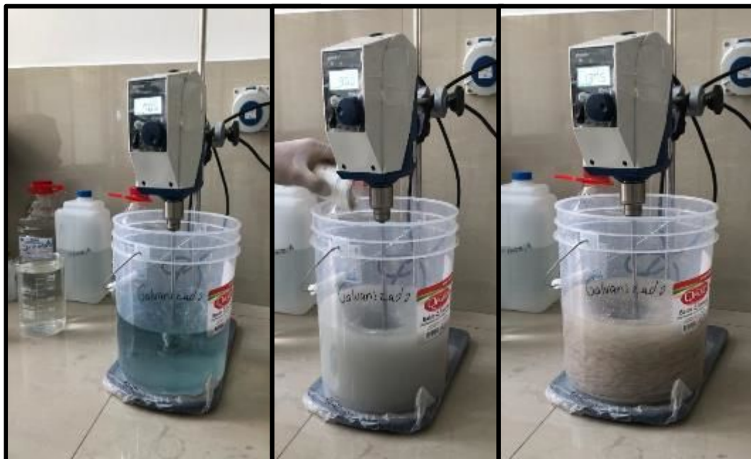
Figura 1. Proceso de Coagulación-Floculación. Fuente: propia
