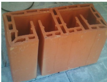
Figura 1: Bloco cerâmico acústico em escala real. Fonte: Autor do Trabalho.
