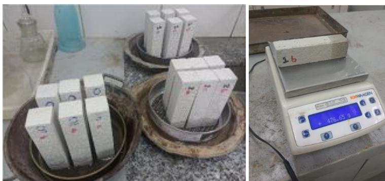
Figura 4: Ensaio de absorção de água (esquerda), coleta de informações aos 10 minutos (direita). Fonte: Autor do Trabalho.
