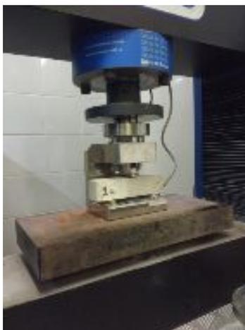
Figura 5: Ensaio para determinação da resistência a flexão. Fonte: Autor do Trabalho.
