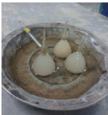
**Figura 2: Determinação da densidade real para a escória de alto-forno. Fonte: Autor do Trabalho.**
