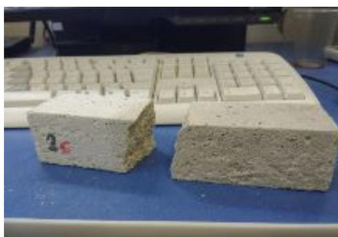
Figura 6: Corpo de prova rompido no ensaio de resistência a flexão e preparação para o ensaio de resistência à compressão. Fonte: Autor do Trabalho.
