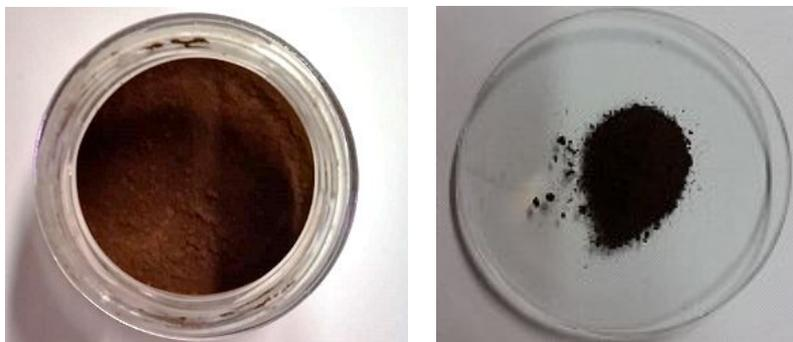
**Figura 1: Material obtido da síntese do óxido de ferro incorporado ao carvão ativado. Fonte: Autor do Trabalho.**
