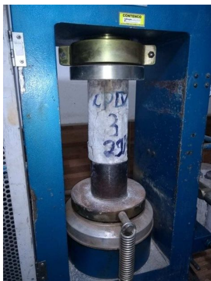
Figura 4: Teste de compressão Fonte: Autores (2018)
