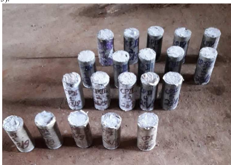
Figura 3: Corpos de prova com suas réplicas e suas diferentes composições.
