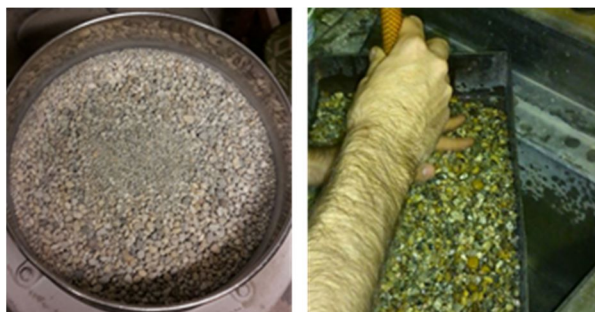
Figura 6: Agregado reciclado retido na peneira 1,6 mm e lavagem. Fonte: Autores, 2019.
