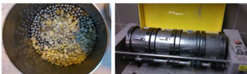
Figura 3: Tambor com agregados e esferas metálicas e máquina utilizada no ensaio. Fonte: Autores, 2019.
