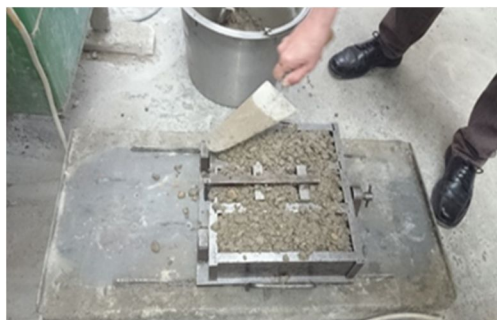
Figura 2: Aplicação do concreto na forma. Fonte: Autores, 2019.
