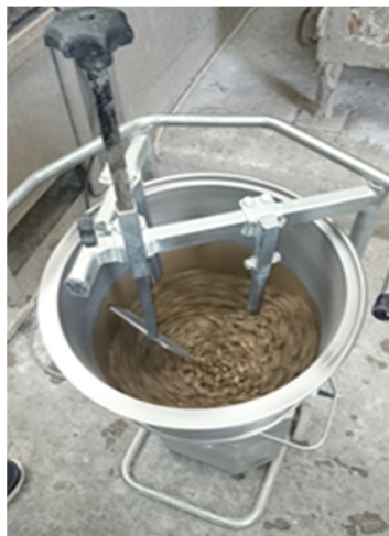
Figura 1: Mistura do concreto. Fonte: Autores, 2019.
