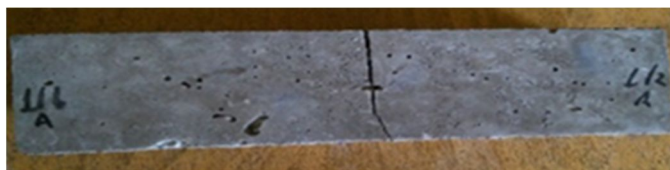
Figura 4: Amostra partida (com falha). Fonte: Autores, 2019.
