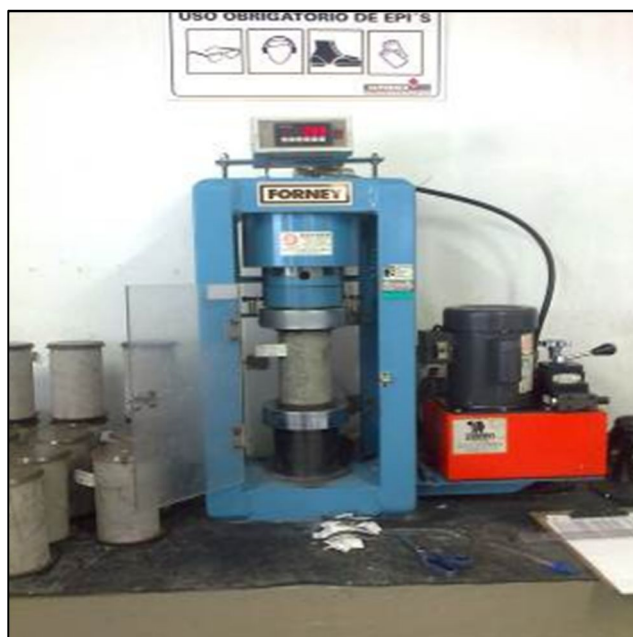
Figura 3: Máquinas para o ensaio de rompimento dos corpos-de-prova. Fonte: Autores do Trabalho.
