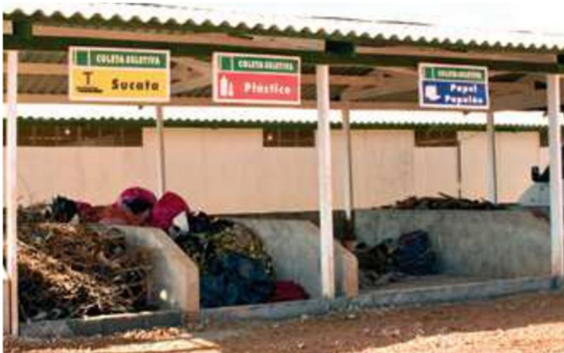
Figura 5: armazenamento indicado para os resíduos em obra. Fonte: Sítio Pini Editora.
