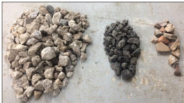
Figura 1 – Caracterização visual do agregado reciclado. Fonte: Autoras do trabalho
