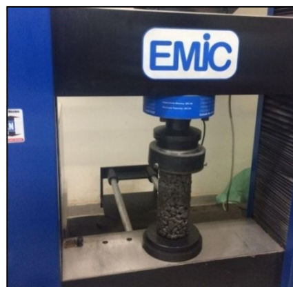
Figura 4 – Cura dos corpos de prova e rompimento aos sete dias. Fonte: Autoras do trabalho
