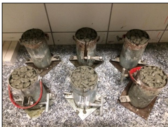
Figura 4 – Cura dos corpos de prova e rompimento aos sete dias. Fonte: Autoras do trabalho
