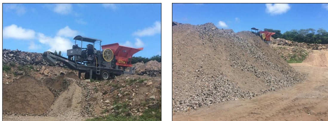
Figura 1 – Processo de beneficiamento do RCD. Fonte: Autoras do trabalho.
