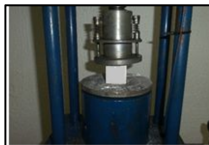
Figura 8: Sequência de produção e ensaio de compressão nas barrinhas. Fonte: Arquivo pessoal, 2018.
