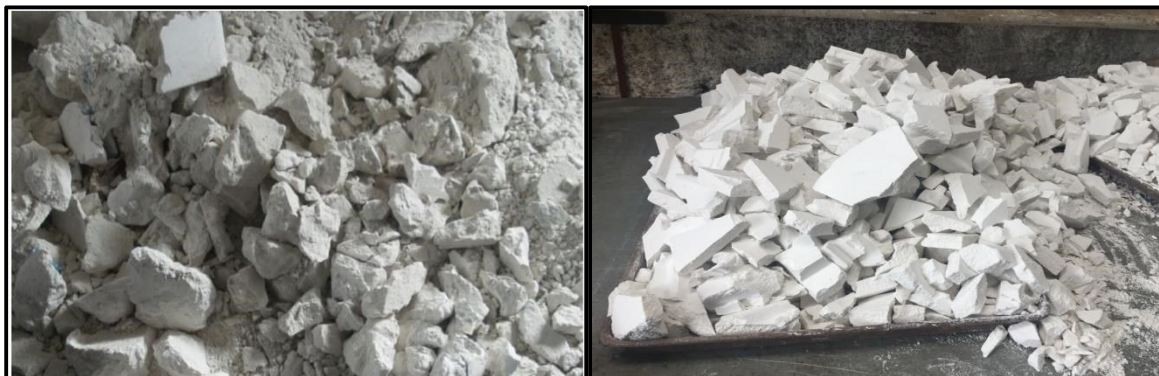
Figura 1: Resíduos de gesso utilizados na produção do Gesso Reciclado fornecidos pela MM Gesso. Fonte: Arquivo pessoal, 2018.
