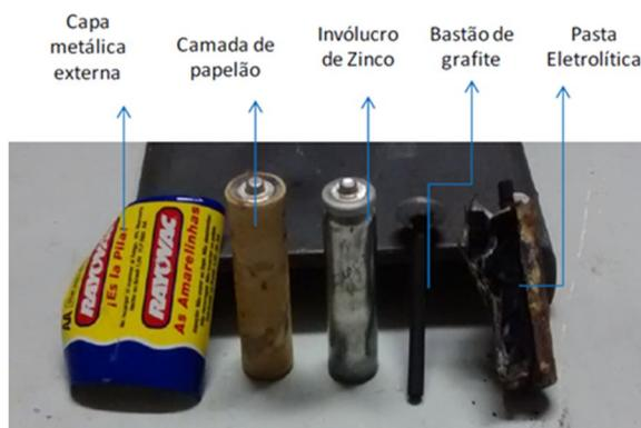
Figura 1: Desmontelamento da pilha. Fonte: NETO, 2015.
