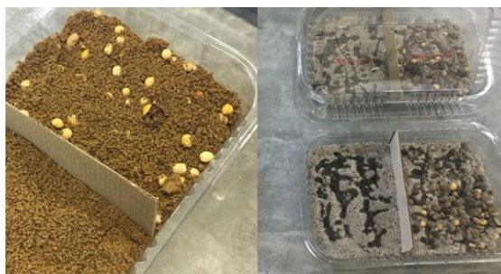
Figura 1 – Imagem dos recipientes contendo as divisórias de papelão. Método utilizado para separar amostras de solo controle e contaminado.
