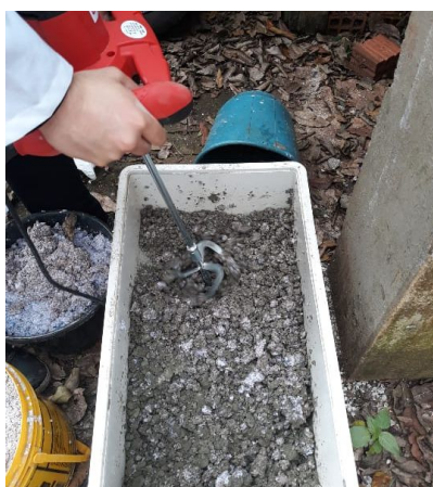
Figura 2: Processo de mistura do compósito. Fonte: Autores, 2018
