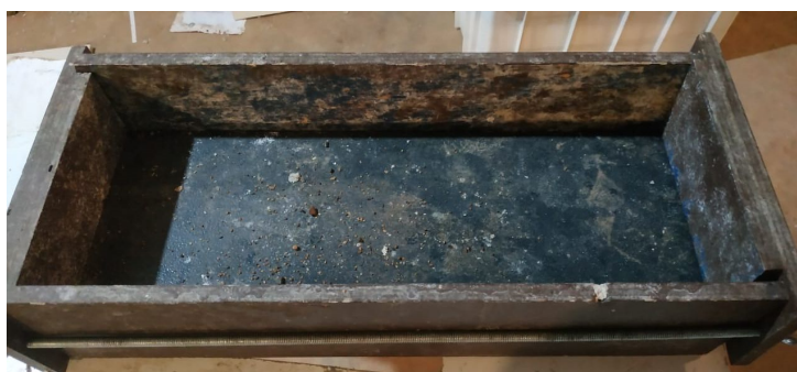
Figura 1: Forma desmontável utilizada na produção dos blocos. Fonte: Autores, 2018
