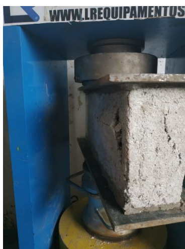
Figura 4: Ensaio de resistência a compressão, deformação característica do bloco. Fonte: Autores, 2018
