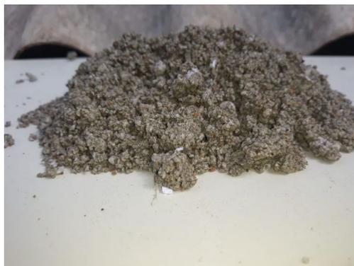
**Figura 2: Massa composta de papel, agregado fino de concreto, areia e cimento. Fonte: Autor do Trabalho.**
