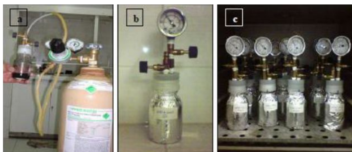
Figura 1. Etapas do teste BMP, onde: (a) Circulação de nitrogênio nos biorreatores; (b) fechamento dos biorreatores e inserção dos manômetros; (c) incubação dos biorreatores em estufa à temperatura mesofílica constante de 37°C. Fonte: Alves (2008).
