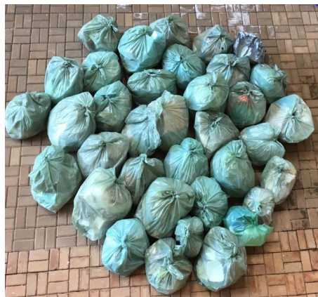
Figura 1: Preparo dos resíduos sólidos para amostragem conforme o quarteamento (ABNT, 2004). Fonte: Autor do Trabalho.
