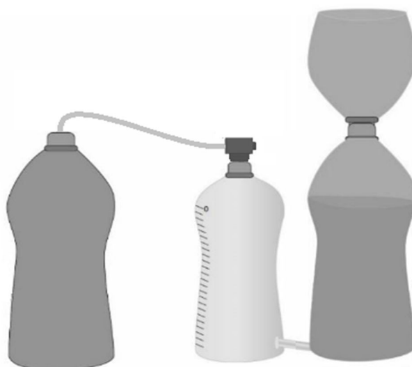
Figura 1. Biodigestor anaeróbio conectado ao medidor de biogás. Fonte: Adaptado de Lourenço (2017).
