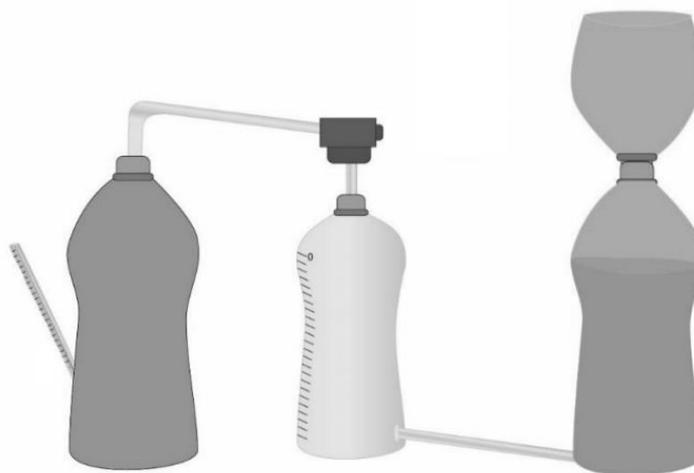
**Figura 1: Biodigestor (à esquerda) e sistema de medição (ao centro, frasco volumétrico, e à direita, reservatório).**
