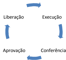
Figura 6: Ciclo diário de inspeção dos serviços executados. Fonte: Autor do Trabalho.
