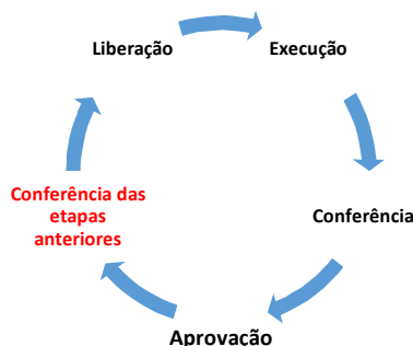
Figura 8: Novo ciclo diário para inspeção dos serviços executados. Fonte: Autor do Trabalho.
