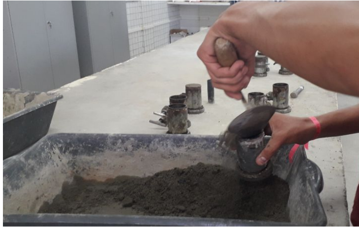
Figura 5. Moldagem das argamassas A e B para cálculo do IAP.
