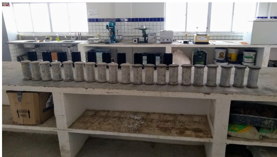
Figura 7. Corpos de prova 10x20 já moldados e capeados – Traço convencional e Traços com cinza.
