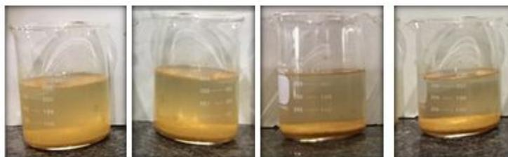
**Figura 2 - Após 6h de tratamento (Ph=2,60 - 25°C); após 12h de tratamento (Ph=2,61 - 24°C); após 24h de tratamento (Ph=2,52 - 30°C) e após 36h de tratamento (Ph=3,81 - 25°C)**
