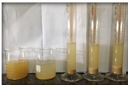
**Figura 1: Início dos testes, da esquerda para a direita: Cloreto de ferro, Sulfato de alumínio, Moringa triturada (2,5%), Moringa triturada (5%), Moringa triturada (7,5%).**
