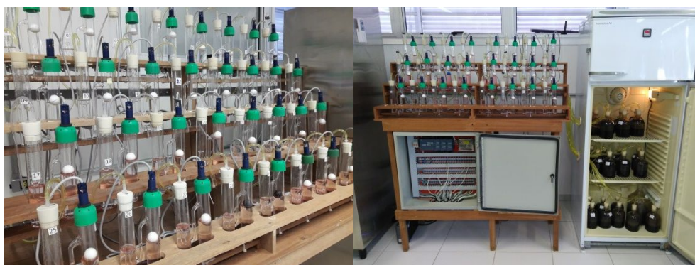
Figura 2: Incubadora bacteriológica e sistema automatizado de medição de biogás - SAMB. Fonte: CPETS - Centro de Pesquisa em Energias e Tecnologias Sustentáveis.
