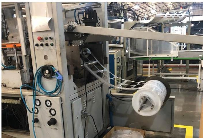
Figura 3 - Geração de aparas no processo de formação. Fonte: Autoria Própria (2019).
