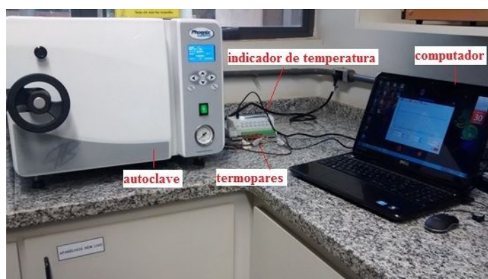
Figura 2: Equipamentos devidamente instalados para os testes com autoclavagem. Fonte: Autores.
