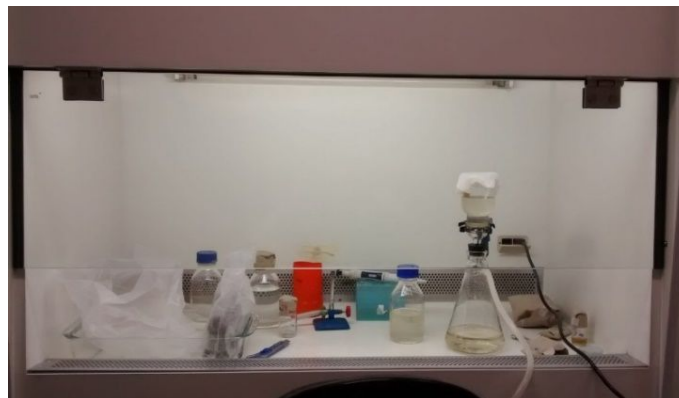
Figura 3: Materiais e sistema de filtração utilizados na recuperação dos endósporos. Fonte: Autores.
