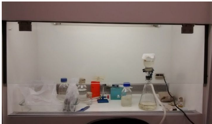
Figura 2: Materiais e sistema de filtração utilizados na recuperação dos endósporos. Fonte: Autores.
