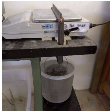
Figura 2. Ensaio de massa específica e absorção dos agregados graúdos
