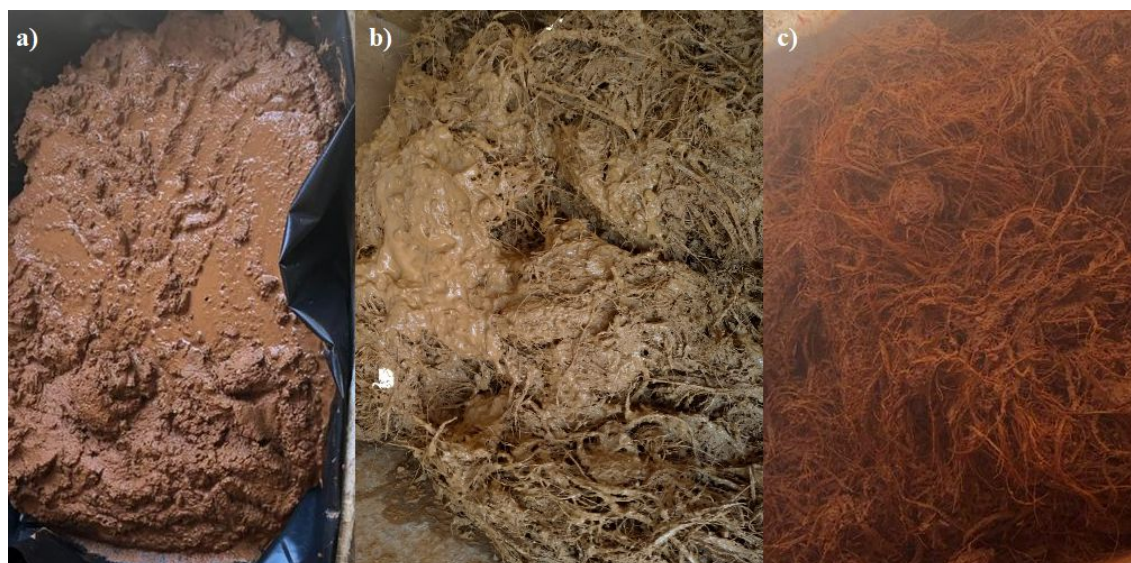
Figura 02: Massas utilizadas para a confecção dos blocos de adobe. (a) Massa T00, (b) massa T05 e (c) massa T10. Fonte: Autor do Trabalho.
