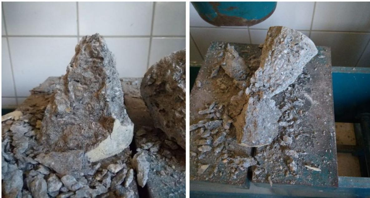
**Figura 7: Forma de Ruptura dos Corpos de Prova. Fonte: Autor do Trabalho.**
