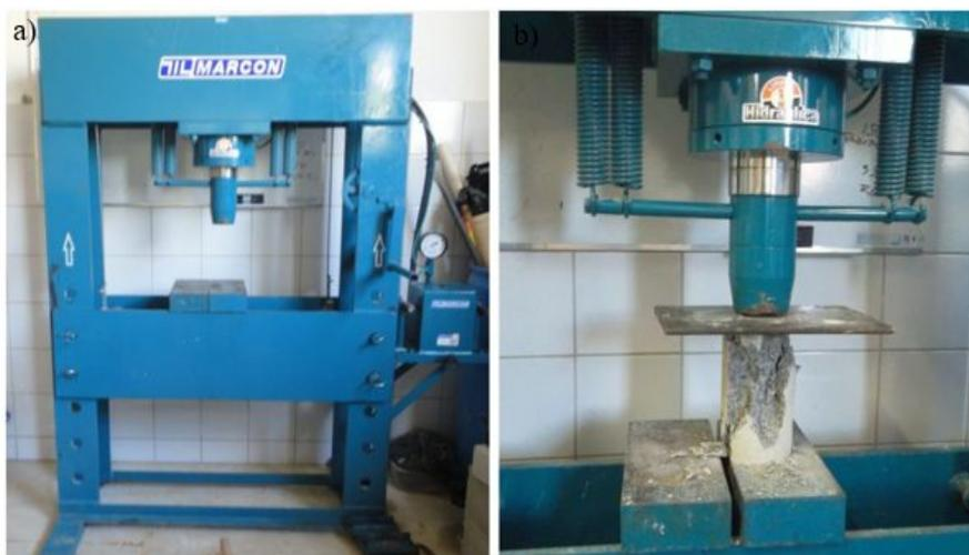
**Figura 4: Ensaio de Compressão Axial: a) Prensa Mecânica; b) Rompimento do Corpo de Prova. Fonte: Autor do Trabalho.**
