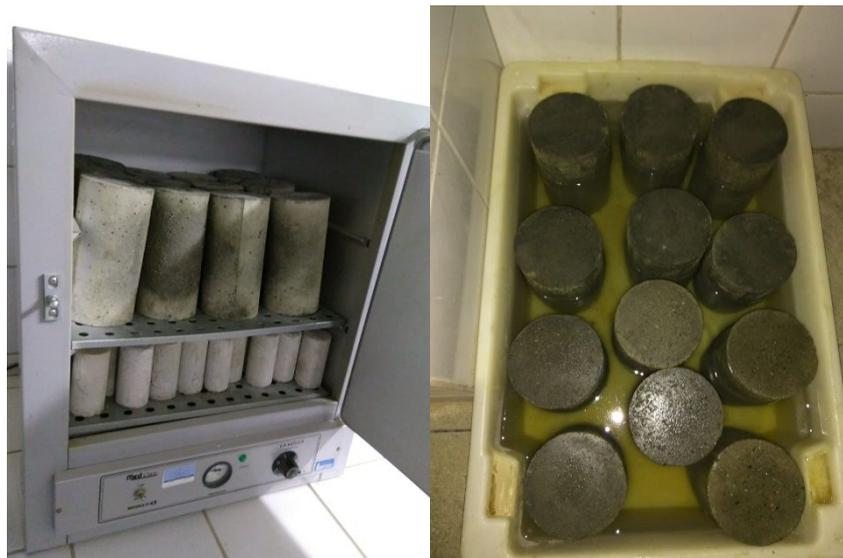
Figura 5 - Determinação da Absorção por Imersão dos Corpos de Prova Cilíndricos. Fonte: Autor do Trabalho.
