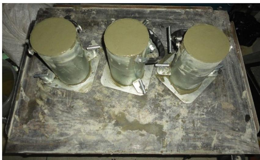
**Figura 2: Moldagem e Vibração dos Corpos de Prova. Fonte: Autor de Trabalho.**
