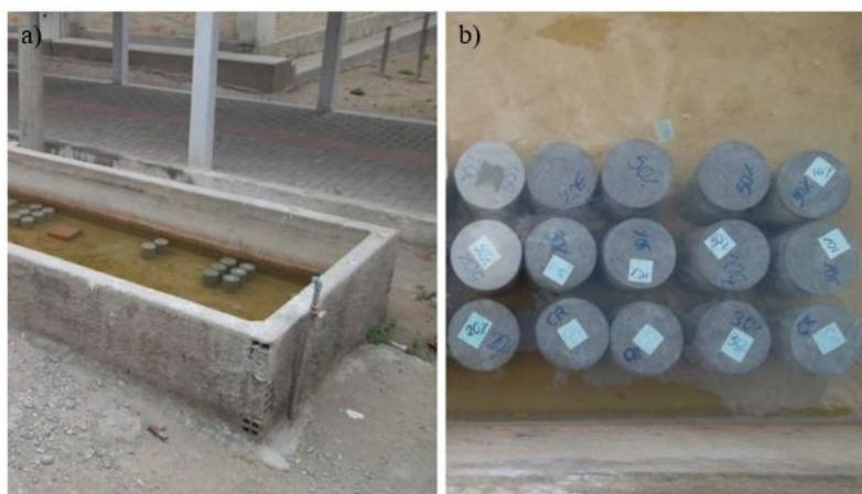
**Figura 3: Processo de Cura dos Corpos de Prova. Fonte: Autor do Trabalho.**
