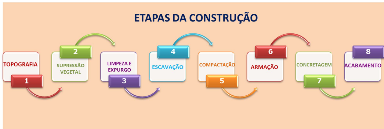
Figura 1: Etapas da construção. Fonte: Autora do Trabalho.
