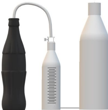
Figura 1: Biodigestor conectado ao medidor de biogás Fonte: Nadaleti et al., 2020
