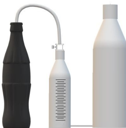
Figura 1: Biodigestor conectado ao medidor de biogás
