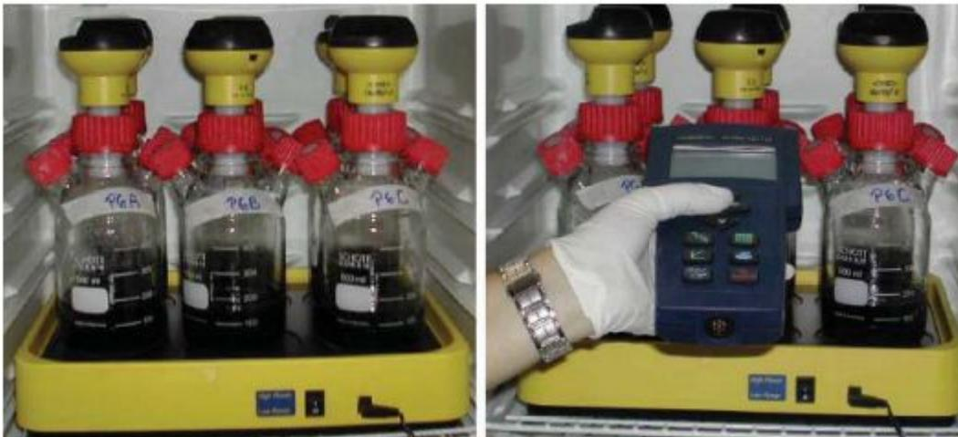
Figura 5: Sistema Oxitop® para a medição de AME. Fonte: Borges (2004).
