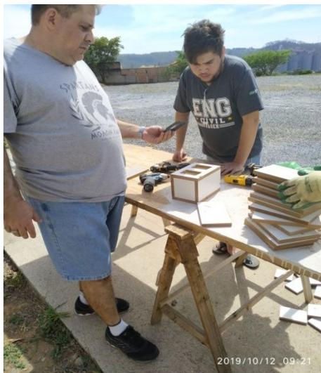
**Figura 3: Estrutura do Totem com corte para montagem das tomadas. Fonte: Autores (2019)**
