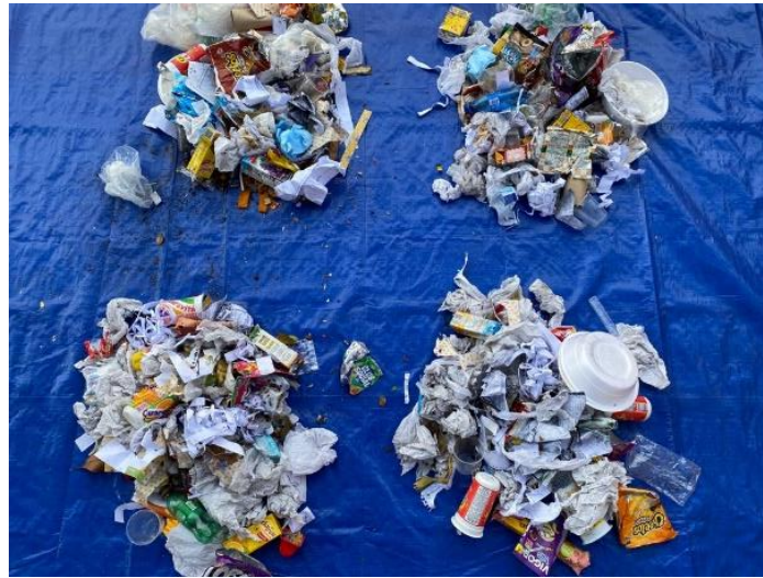
Figura 5: Quarteamento da amostra de resíduos conforme NBR 10007:2004. Fonte: Autor do trabalho.
