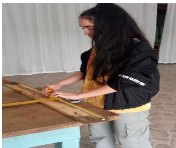
Figura 3: Marcação das medidas nas peças para corte. Fonte: Autores do Trabalho.
