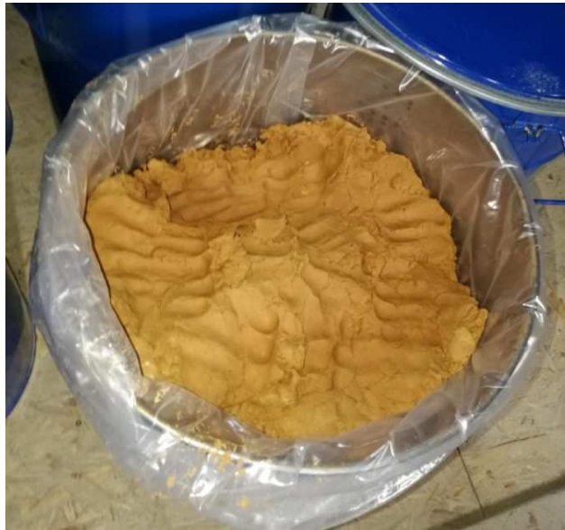
Figura 1: Polpa de madeira obtido da mistura de pó, partículas de madeira e polímero. Fonte: Decorline.
