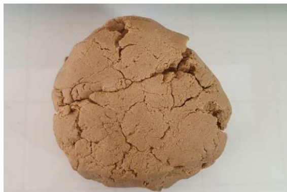
Figura 4: Pasta da polpa de madeira obtida nos ensaios de laboratório. Fonte: autor do trabalho.
