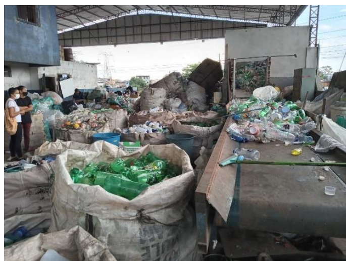
Figura 6: Esteira para a triagem de resíduos na ARAL e COOCAPE. Fonte: Autor do Trabalho.
