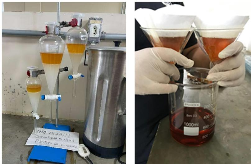
Figura 1: Decantação e filtração do óleo usado de cozinha.
