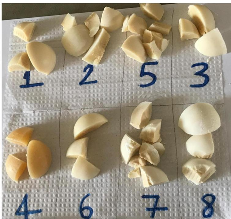
**Figura 5: Evidência da dureza e do corte dos sabões após 15 dias de maturação (ver Tabela 2).**
