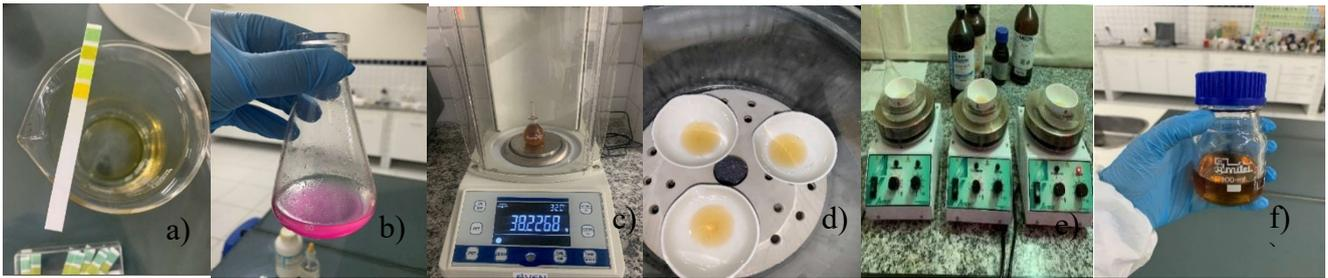
Figura 05: Parâmetros do óleo vegetal residual a) pH b) acidez c) densidade d) umidade e) impurezas f) microbiológico Fonte: Autor do trabalho.
