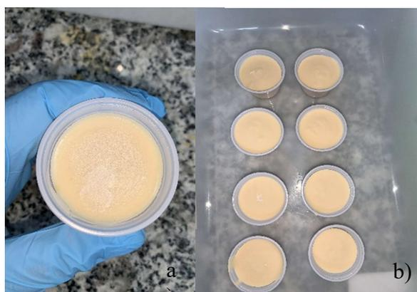
**Figura 10: Teste de resistência a exposição a luz**
