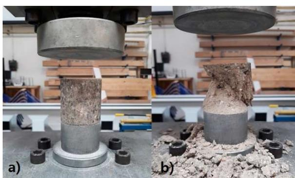
Figura 3 – Imagens do ensaio de resistência à compressão axial dos corpos de prova antes a), e após rompimento b). Fonte: Autores.
