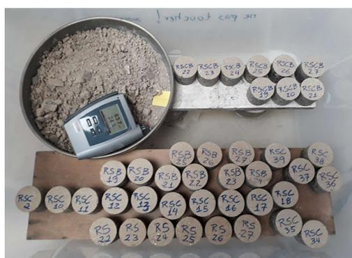
Figura 2 – Tijolos comprimidos na câmara úmida. Fonte: Autores.
