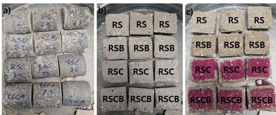
Figura 12 – Imagens do ensaio de carbonatação com fenolftaleína antes a), b) e após o ensaio c). Fonte: Autores.
