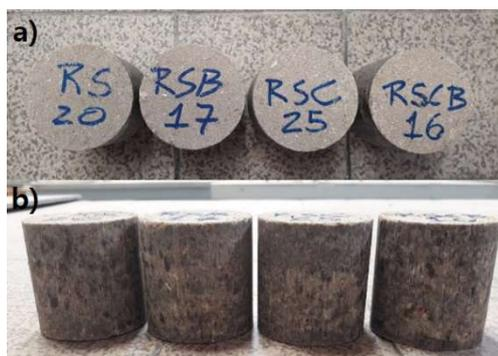
Figura 1 – Imagem dos tijolos comprimidos em vista superior a), e vista lateral b). Fonte: Autores.
