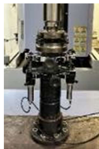
Figura 3: Ensaio de compressão uniaxial. Fonte: Autor do Trabalho.
