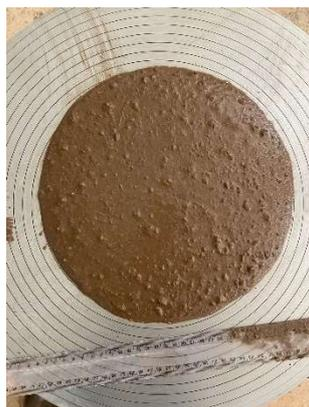
**Figura 1: Realização do ensaio de consistência. Fonte: Autor do Trabalho.**
