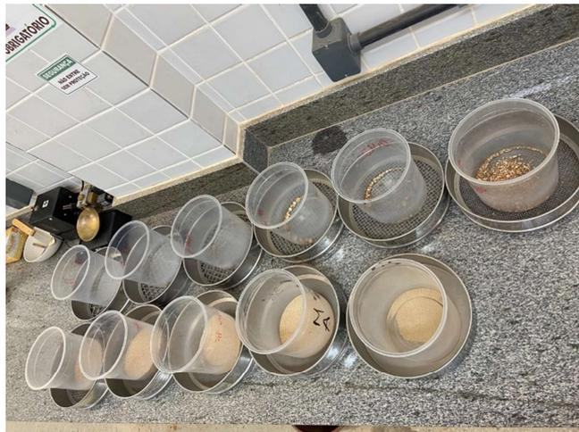
Figura 5: Ensaio de granulometria da areia e do RCD. Fonte: Autor do Trabalho.
