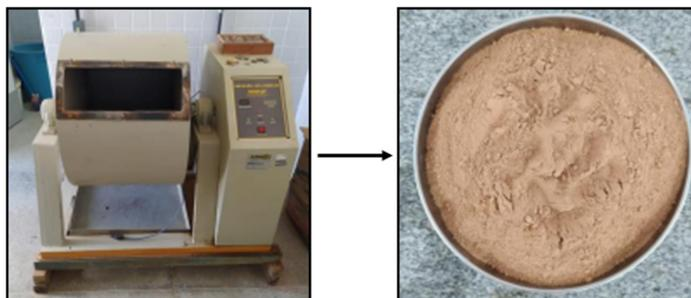
Figura 2: Processo de trituração do RCD. Fonte: Autor do Trabalho.
